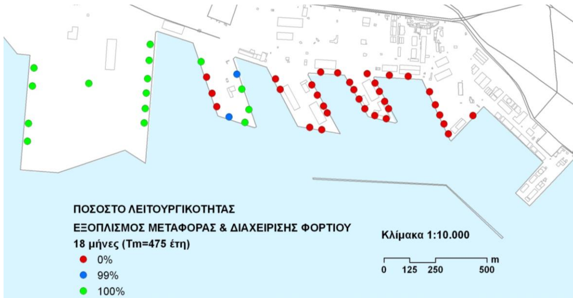
Σχήμα 16. Παράδειγμα σχεδιασμού της αποκατάστασης βλαβών στον εξοπλισμό μεταφοράς και διαχείρισης φορτίου λιμένα Θεσσαλονίκης. α) Αναμενόμενες βλάβες λόγω εδαφικής ταλάντωσης και εδαφικής αστοχίας (ρευστοποίηση) για ένα σεισμικό σενάριο με περίοδο επαναφοράς 475 έτη. β) Ιεράρχηση της σπουδαιότητας. γ) Προτεραιότητες αποκατάστασης. δ-ε) Πορεία αποκατάστασης βλαβών σε 3 και 18 μήνες μετά το σεισμό
