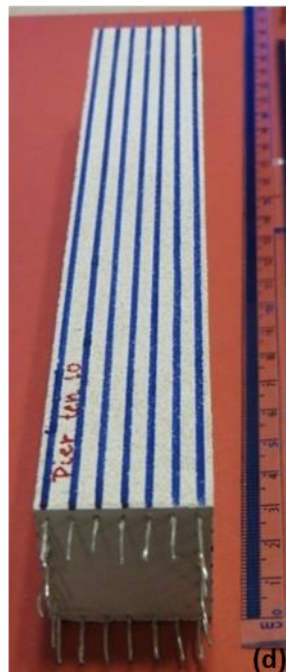
Σχήμα 1. Κατασκευή μοντέλου βάρου σπλισμένου σκυροδέματος: (a) διαμήκης σπλισμός; (b) συνδετήρες; (c) σιδηρότυπος εντός της συσκευής σκυροδέτησης και (d) μοντέλο βάρου
