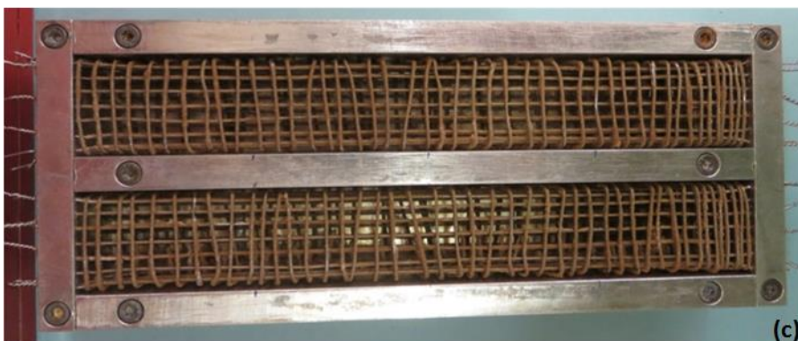
Σχήμα 1. Κατασκευή μοντέλου βάρου σπλισμένου σκυροδέματος: (a) διαμήκης σπλισμός; (b) συνδετήρες; (c) σιδηρότυπος εντός της συσκευής σκυροδέτησης και (d) μοντέλο βάρου
