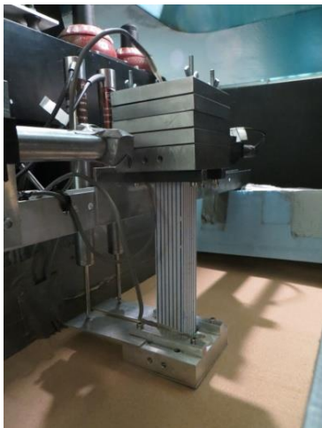
Σχήμα 3. Πειραματική διάταξη επί φυγοκεντριστή: (α) τομή του μοντέλου μέσα σε διατμητικό κουτί, παρουσιάζεται η εγκατάσταση των οργάνων μέτρησης; Πειραματική διάταξη επί φυγοκεντριστή πριν (b) και μετά (c) τη στροφή της βάσης.
