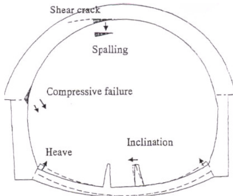
Βλάβες στη σήραγγα Rokko
