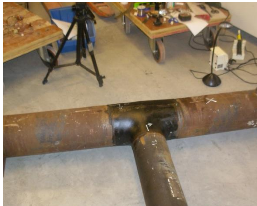
Σχήμα 27: Σύνδεση τύπου "fitting"(αριστερά) (Paratheocharis et al. 2013).
