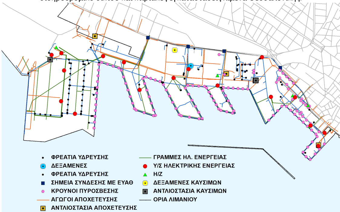
Σχήμα 5.2. Δίκτυο ηλεκτρικής ενέργειας, δίκτυο υγρών καυσίμων, δίκτυο ύδρευσης, δίκτυο πυρόσβεσης και δίκτυο αποχέτευσης λιμένα Θεσσαλονίκης.
