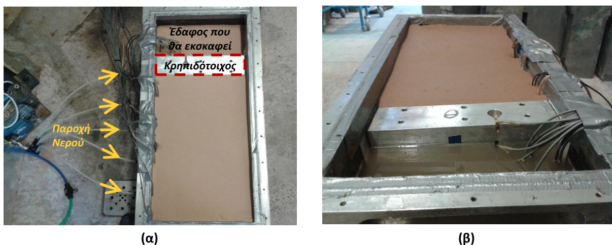
Σχήμα 7 Φωτογραφίες από τη διαδικασία ενυδάτωσης του πειραματικού ομοιώματος: (α) πριν και (β) μετά από την εκσκαφή του εδάφους έμπροσθεν του τοίχου.
